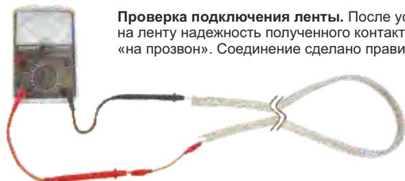
**Проверка подключения ленты.** После установки игольчатого разъема на ленту надежность полученного контакта необходимо проверить тестером «на прозвон». Соединение сделано правильно, если каждый «закругленный» контакт установленного разъема «звонится» (имеет надежный контакт) только с одним соответствующим контактом провода на другом конце отрезка ленты и «не звонится» (не имеет короткого замыкания) ни с одним другим.
