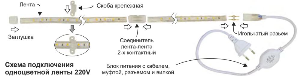
Схема подключения одноцветной ленты 220V
