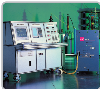
Проверка характеристик вакуумного автоматического выключателя
