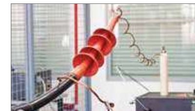
Высоковольтные испытания кабельных муфт
