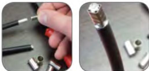
Предназначены для оконцевания методом опрессовки гибких многопроволочных медных проводников.
